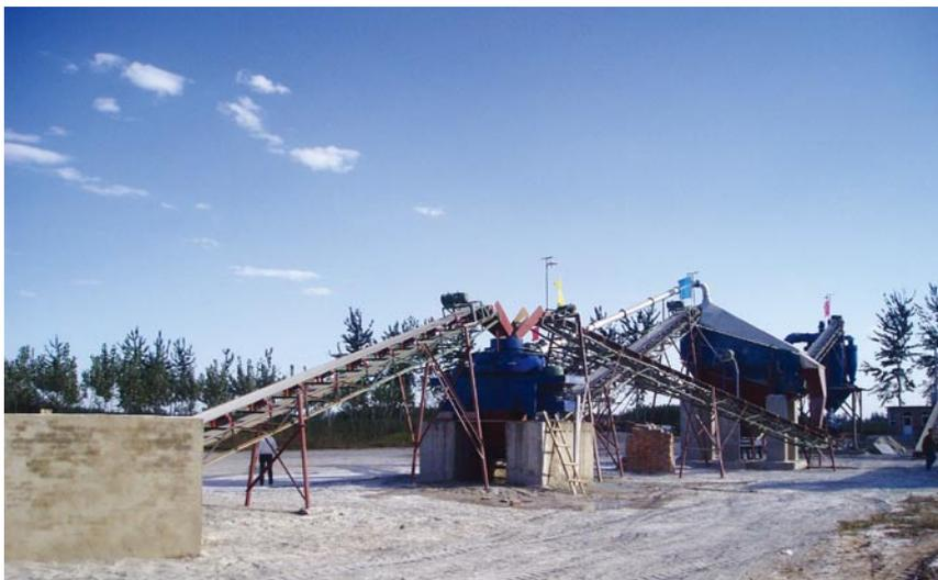
该生产线可用于生产SMA路面中所需的机制砂和石粉，也可用于玄武岩集料整形及生产同步碎石封层所需的骨料。
