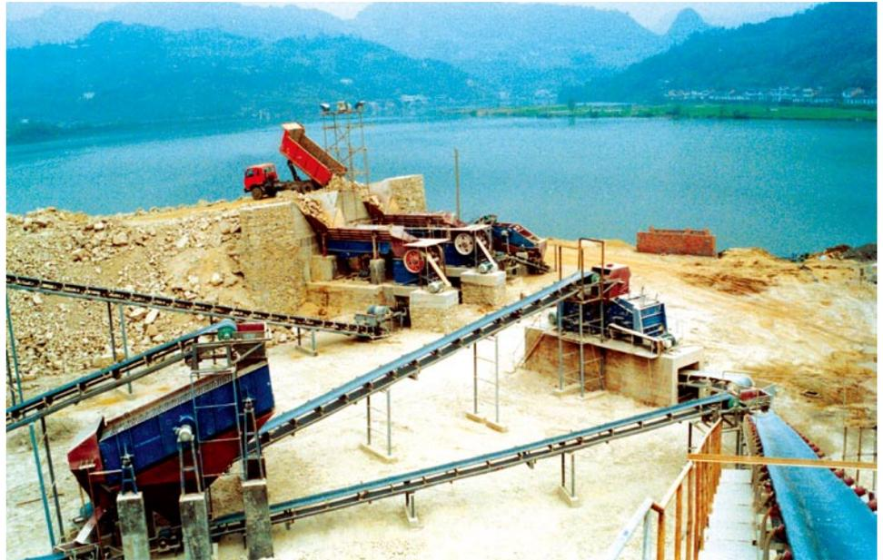
Система обработки заполнителя производительностью 400тонн/час сычуаньской ГЭС на реке Мабяньхэ
